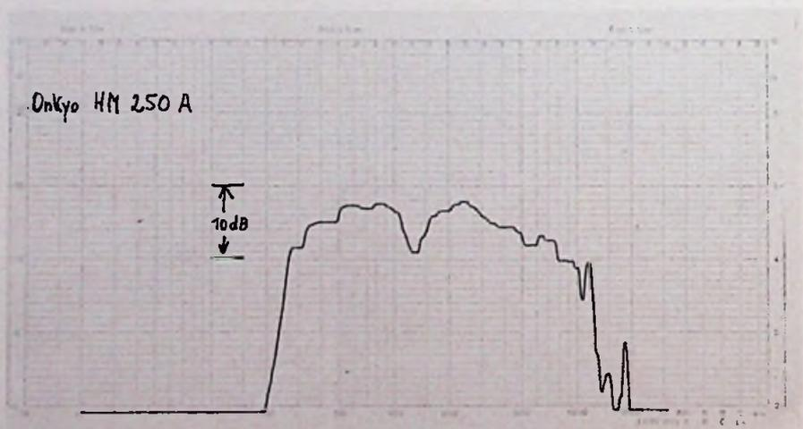
**Bild 2.** Übertragungskennlinie des „HM-250A“
